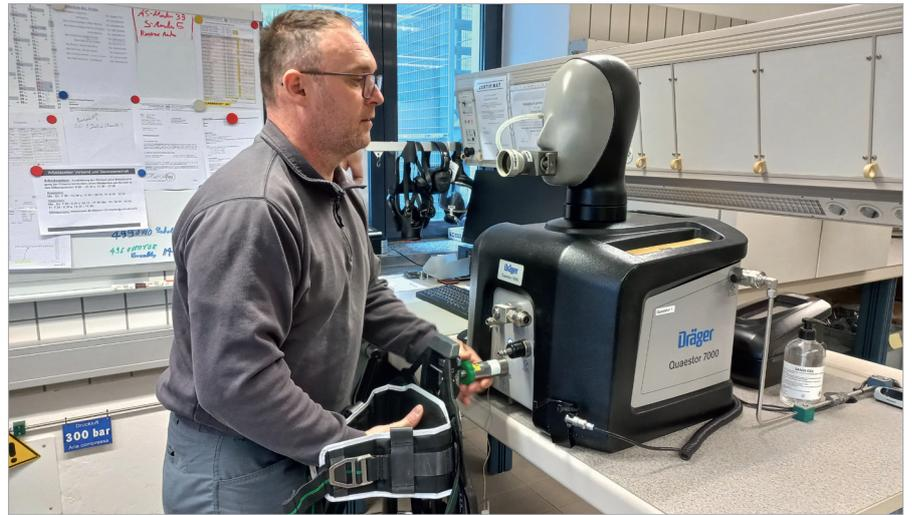
Überprüfung eines Atemschutzgerätes
