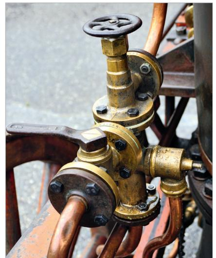
*Injektor zur Wasserspeisung*
