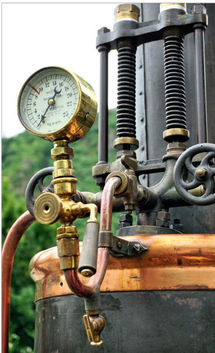
*Druckmanometer und Sicherheitsventile*
