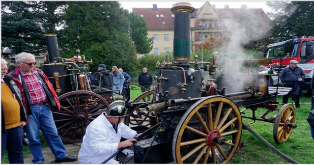
Dampfspritze der Stadtfeuerwehr Svojanov (Tschechien); Hersteller: R.A. Smékal – Slatiňany (Tschechien); Baujahr: 1908; Förderleistung 300 l/min bei 9 atm
