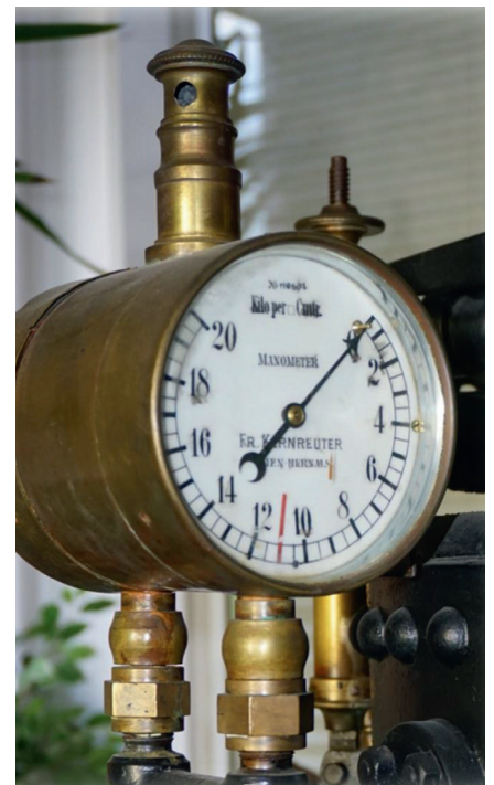
Manometer mit Kondens-Entleerungshahn
