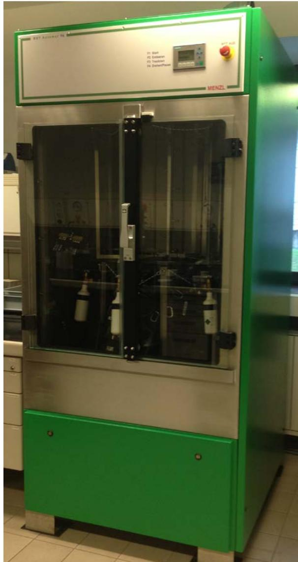
*Im Bild: Bis zu 12 Pressluftatmer können in einem Durchgang desinfiziert und gewaschen werden.*
