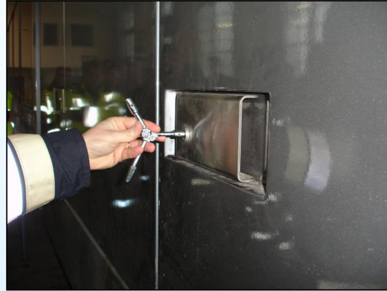
Alle Fenster und Glasscheiben (außer die Frontscheibe der Fahrerkabinen) bestehen aus einer Doppelverglasung aus ESG-Glas und können durchbrochen werden
