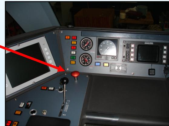
Hauptschalter zur Abtrennung der Batterie
