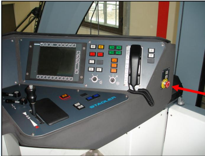
In jeder Fahrerkabine befinden sich **Not-Aus Taster**, der die Abschaltung der Dieselmotoren und der Kraftstoffanlage und eine Bremsung bewirkt.
