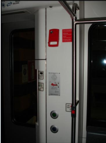
In jedem Einstiegsraum befindet sich eine Fahrgastnotbremse mit Gegensprechanlage zum Fahrzeugführer.
