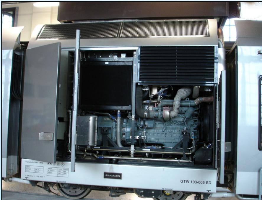
Das **Antriebsmodul** besteht aus **zwei Maschinenräumen**
