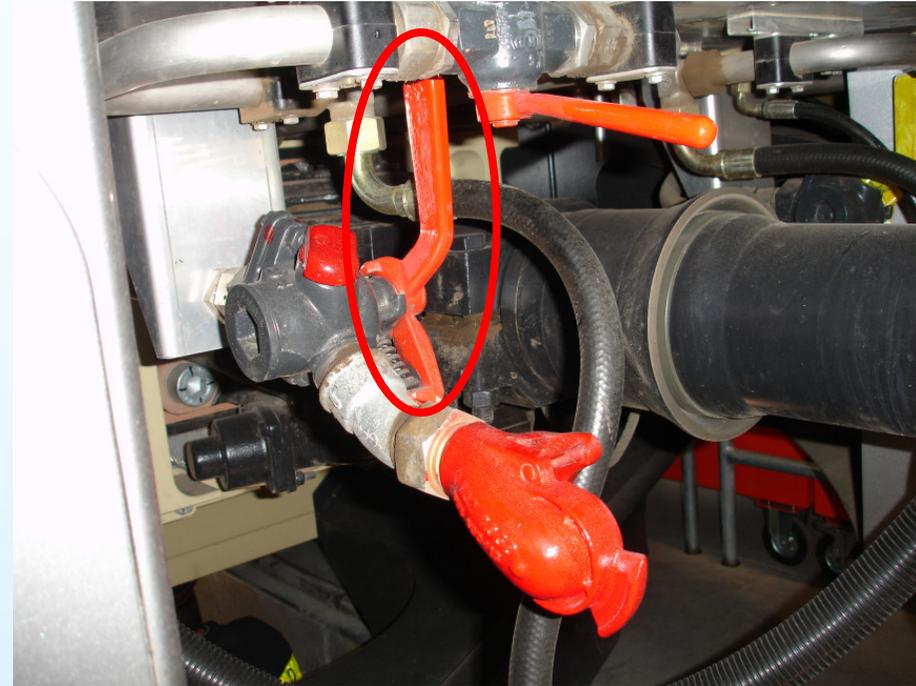
Durch Entleeren der Hauptluftleitung können alle Bremsen angelegt werden.
