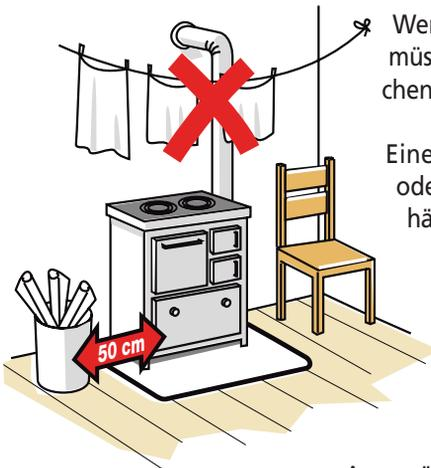
Wenn die Fußböden unter Feuerstätten brennbar sind, müssen sie durch nichtbrennbare Baustoffe mit ausreichender Dicke geschützt werden.
