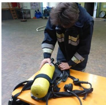
Abb. 28: Hochdruck-O-Ring des PA kontrollieren
