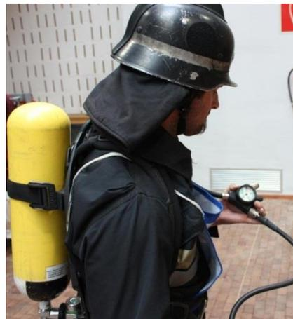
Abb. 6: Aufdrehen der Flaschen und Manometerkontrolle
