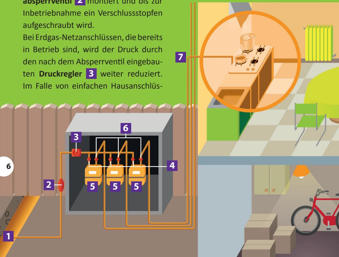
Druckregler und Gaszähler sind in einem geeigneten Gehäuse (Schrank oder Nische) untergebracht.
