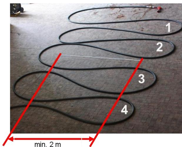
Abb. 23.1: RICHTIGES Auslegen der Schlauchleitung
