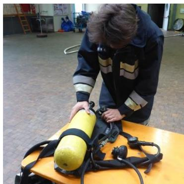
Abb. 28: Hochdruck-O-Ring des PA kontrollieren
