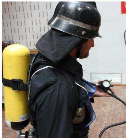
Abb. 6: Aufdrehen der Flaschen und Manometerkontrolle
