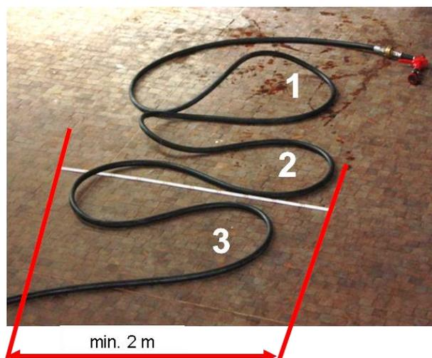
Abb. 23.2: FALSCHES Auslegen der Schlauchleitung
