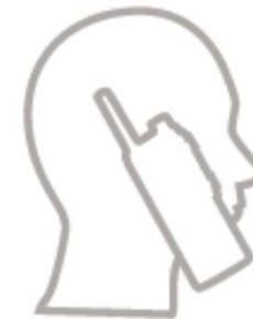
Wenn Sie einen Simplex-Ruf (mit hoher Lautstärke) tätigen, halten Sie das Funkgerät in einer vertikalen Position mit dem oberen Mikrofon 5 bis 10 Zentimeter vom Mund entfernt. Sprechen Sie in das obere Mikrofon. Hören Sie über den internen Lautsprecher des Funkgeräts.
