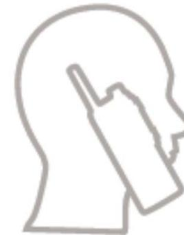
Quando si effettuano chiamate simplex (audio alto), tenere la radio in posizione verticale mantenendo il microfono superiore a una distanza di 5-10 centimetri dalla bocca. Parlare nel microfono superiore. Ascoltare tramite l'altoparlante interno della radio
