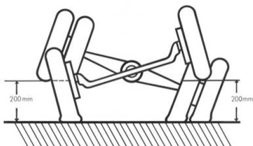
Bild 29: Verschränkungsfähigkeit der Vorderräder
