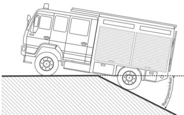
Bild 28: Rampenwinkel
