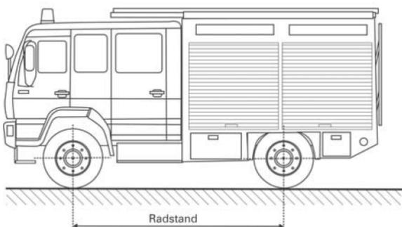
Bild 26: Radstand eines Fahrzeuges
