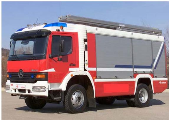
Bild 8: Tanklöschfahrzeug TLF-A 2000 Tr mit Truppbesatzung
