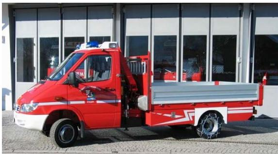
Bild 24: Transportfahrzeug TF mit Ladekran
