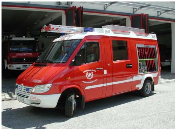
Bild 3: Kleinlöschfahrzeug KLF mit Gruppenbesatzung
