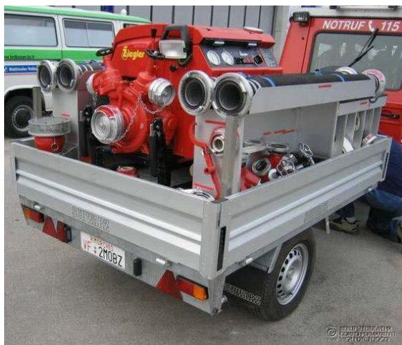
Bild 2: Tragkraftspritzenanhänger TSA
