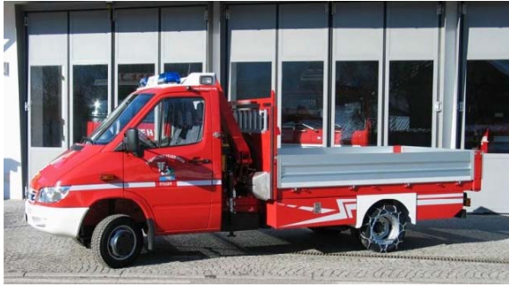
Bild 24: Transportfahrzeug TF mit Ladekran
