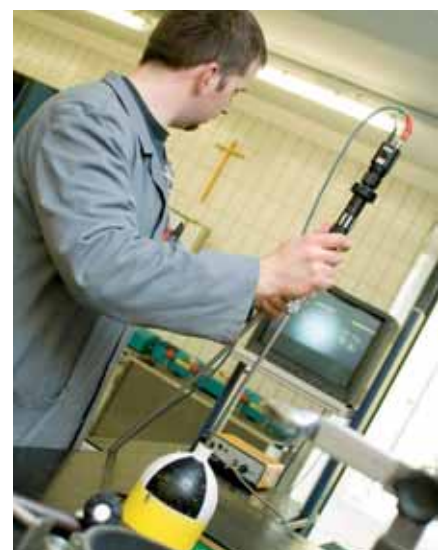
Kontrolle der Pressluftflaschen
