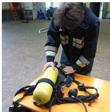
Abb. 28: Hochdruck-O-Ring des PA kontrollieren
