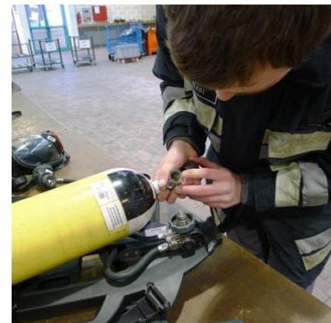
Abb. 29: Das Ventil der Atemluftflasche auf Verunreinigung kontrollieren
