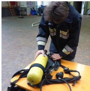
Abb. 28: Hochdruck-O-Ring des PA kontrollieren
