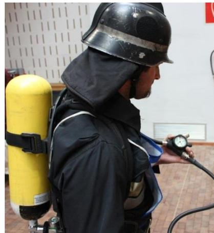
Abb. 6: ganz Aufdrehen der Flaschen und Manometerkontrolle
