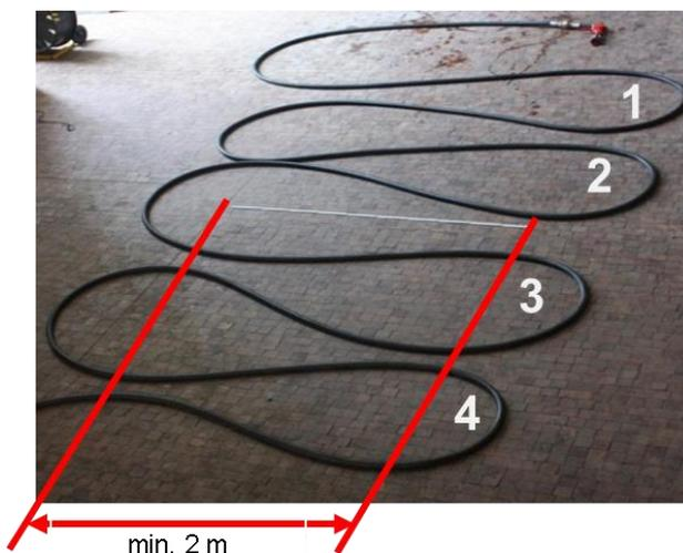
Abb. 23.1: RICHTIGES Auslegen der Schlauchleitung
