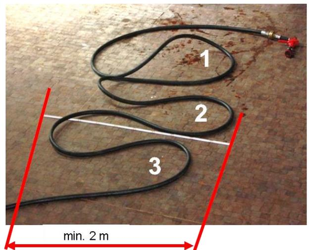
Abb. 23.2: FALSCHES Auslegen der Schlauchleitung
