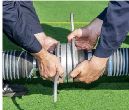
Es ist jedoch auch bestimmungskonform, wenn der Kupplungsschlüssel nur mit beiden „Nasen“ den Metalteil der unteren Fläche der Kupplung berührt (untere Fläche der Kupplung: siehe Abb. 30.)
