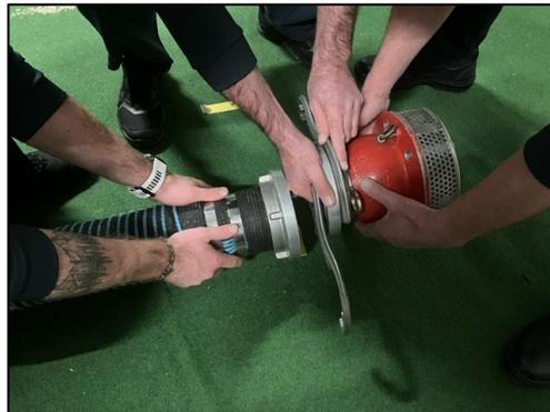
Saugkorbübergabe mit bereits aufgesetzten Kupplungsschlüssel – Fehler „Falsches Arbeiten“
