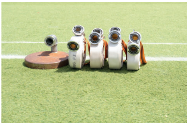
Abb. 12: Aufstellung der vier C-Druckschläuche
