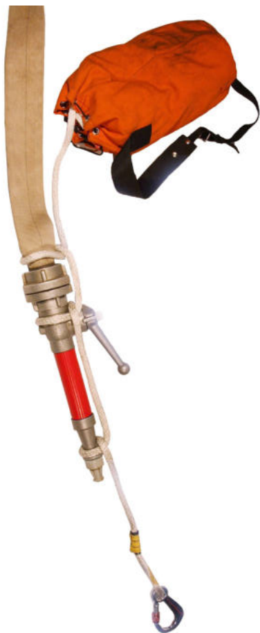
Abb. 51: Kreuzknot und halber Schlag am Strahlrohr (ÖBFV)
