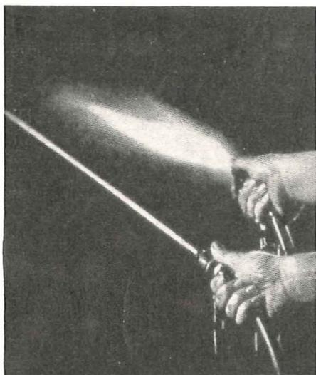
**Wasser-Sprühstrahl eignet sich nicht nur zum Lö- schen, sondern auch zum Niederschlagen von Gas- oder Dampfwolken**
