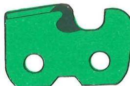
Dieses Zahndach ist ganz stumpf. Das kommt daher, daß der Schneidenwinkel größer als 45 Grad gefeilt wurde. Die Schnittgeschwindigkeit ist viel zu langsam, denn die Schnittkante der Zahnbrust verläuft fast senkrecht, vermag das Holz nicht zu zerspanen und bremst.
