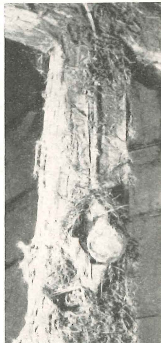
Leuchtstofflampen-Leuchte mit 65-W-Lampe, völlig mit Häcksel umgeben, führte nach 3½ Tagen zum Brand (Versuchsanlage).
