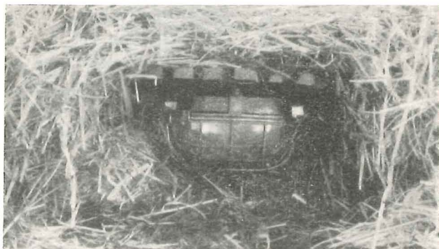
Iso-Ovalleuchte mit 40-W-Glühbirne, die ganz in Häcksel eingepackt war, führte zum Brand (Versuchsanlage).
