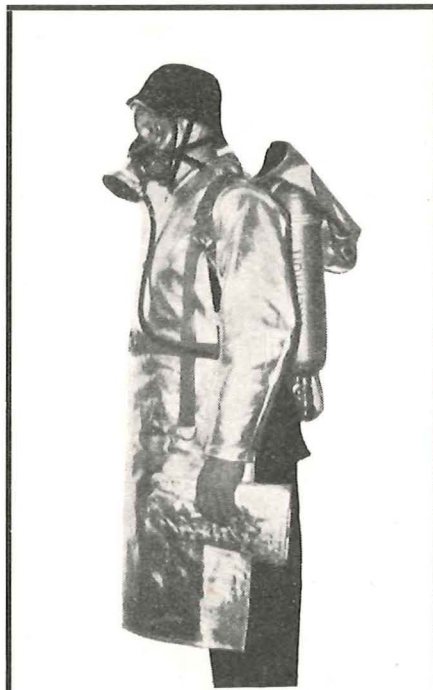
Schutzwirkung gegen Wärmestrahlung, daher besonders für Angriffstrupps geeignet
