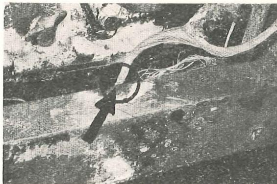
Batteriekabel scheuerte am Chassisrahmen
