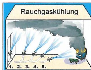
Bild 18: Prinzipskizze zur Rauchgaskühlung und zum Löschen des Brandherdes
