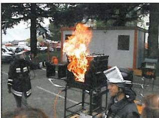
Bild 16: Vorführung einer Rauchdurchzündung (Flash-over) an der Landesfeuerwehrschule mit der »Flash-over-Box«
