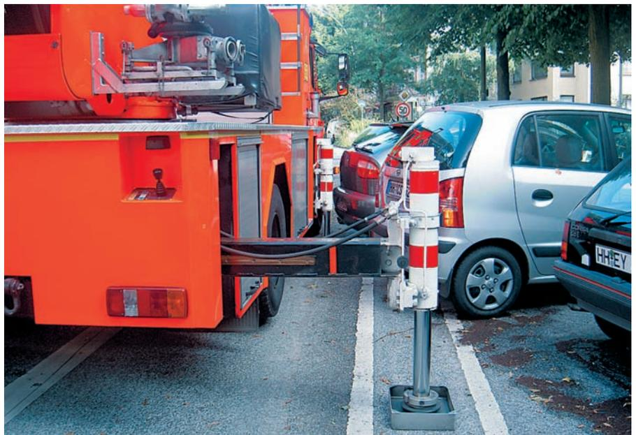
*Belastete Abstützung: In einer engen Straße konnte der vordere Stützzylinder nicht voll ausgefahren werden.*
