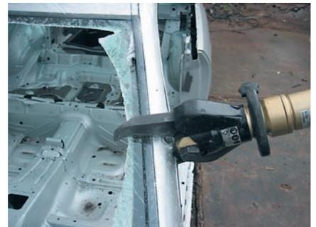
Das Schneidgerät (mit sichelförmigen, gezahnten Messern) bleibt beim Versuch, eine verstärkte Säule zu durchtrennen, stecken.
