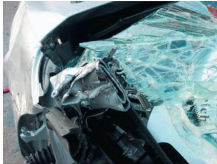
Verstärkte A-Säule eines Mercedes-Benz SLK (Intern R171) nach einem Schneidversuch
