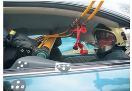
Einsetzen des Rettungszylinders vor dem »Cross-Ramming«
