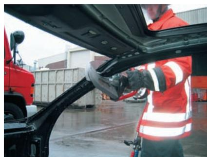
Die Rettungsschere mit sichelförmig geschliffenen Messern durchtrennt die verstärkte A-Säule an einem Mercedes-Benz CLK mit einem Schnitt.
