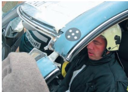
Durch das Spreizen wird das Verstärkungsrohr freigelegt und kann dann durchtrennt werden.
