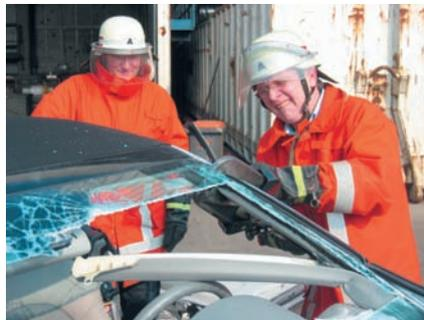
Missglückter Versuch, eine verstärkte Säule mit einem Schnitt zu durchtrennen. Bedingt durch die Messerform, entfernt sich das zu schneidende Karosserieteil vom Messerdrehpunkt (Bolzen) des Schneidgerätes.
