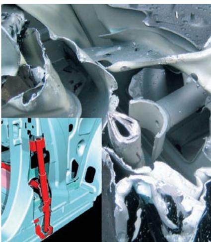
Aufbau der B-Säule eines Mercedes-Benz CLK (kleines Bild), nach dem Versuch zur Schaffung einer »dritten Tür« (großes Bild)
