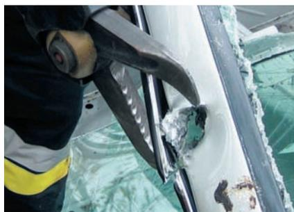
Das Blechkleid um die Verstärkung herum wird mit der Rettungsschere mithilfe eines V-Schnitts herausgeschnitten.
