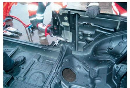
Die Rettungsschere mit sichelförmig geschliffenen Messern durchtrennt das hochfeste Rohr in der B-Säule des Mercedes-Benz-CLK-Coupés.
