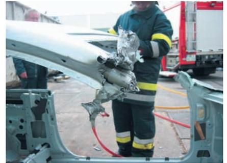
A-Säule eines Mercedes-Benz CLK im oberen Bereich
