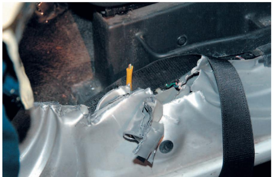
Beim Schneiden (V-Schnitt) der B-Säule im Bereich über dem Fahrzeugschweller kamen zunächst zwei durchtrennte Kabel zum Vorschein. Als der zweite Schnitt durchgeführt wurde, kam es dann zu einem plötzlichen Auslösen des Seitenairbags auf der Beifahrerseite.
