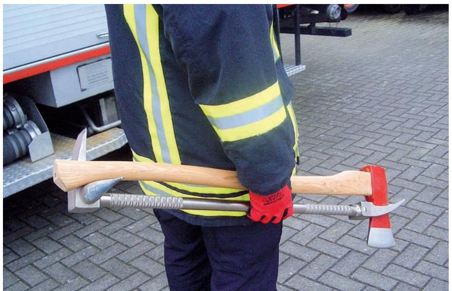
Das Halligan-Tool lässt sich durch Ineinanderstecken sehr leicht mit einer Holzaxt zu einer kompakten Einzeleinheit verbinden.
