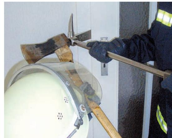
Mithilfe einer Feuerwehrraxt wird die Schneide des Halligan-Tools tiefer in den Spalt zwischen dem Türrahmen und dem Türblatt getrieben.
