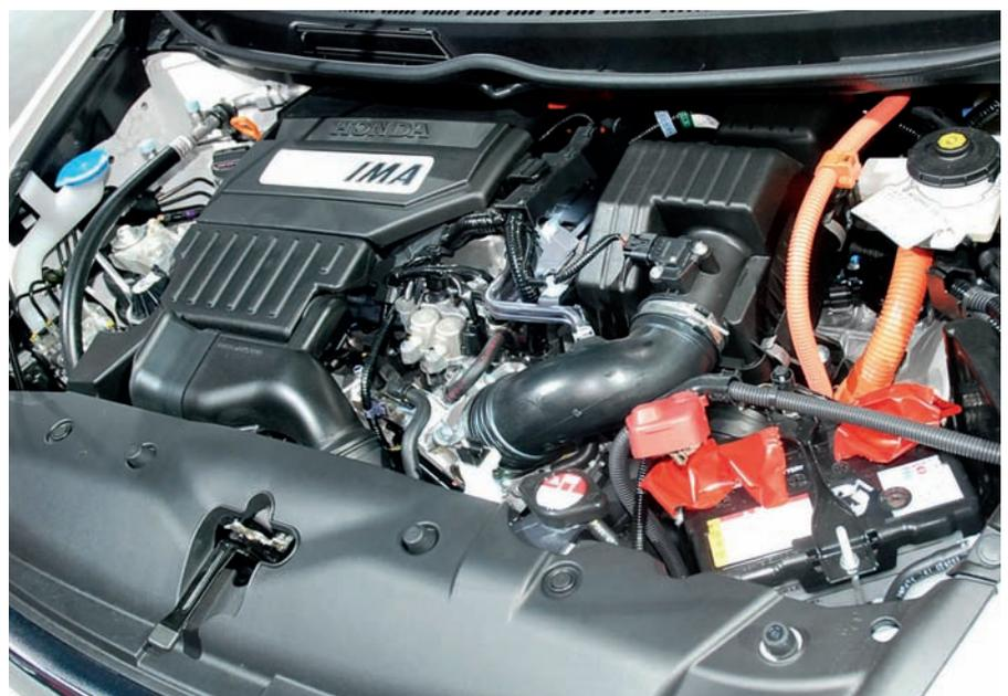
Im Motorraum dieses Honda Civic Ima (Integrated Motor Assist, Hybridfahrzeug) sind neben des IMA-Logo auch orangefarbene Hochvoltkabelverbindungen (rechts im Bild) sichtbar.
