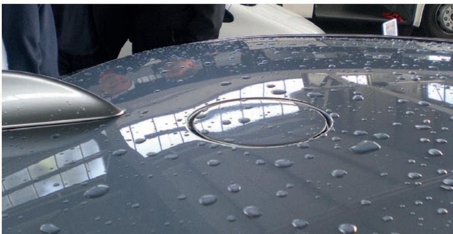
Abblasseinrichtung für Wasserstoff auf dem Dach eines BMW Hydrogen 7
