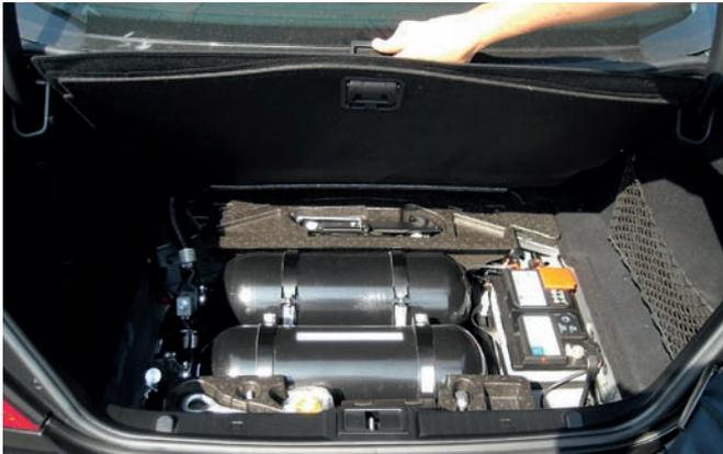
Nach dem Anheben des Kofferraumbodens bei diesem Fahrzeug der Mercedes-Benz E-Klasse werden die Erdgastanks sichtbar.
