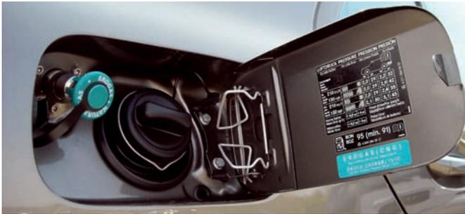
Hinter der Tankklappe eines Pkw der Mercedes-Benz E-Klasse NGT befindet sich ein Tankverschluss für Benzin sowie ein Anschluss für die Betankung mit Erdgas. Zusätzlich ist in der Tankklappe ein Hinweisschild auf das vorhandene Betriebsmittel eingeklebt.
