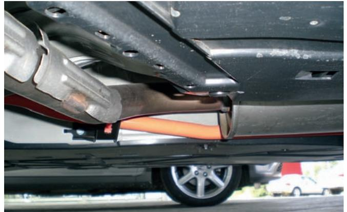
Beim Blick unter diesen Honda Insight Hybrid ist eine orangefarbene Kabelverbindung zu erkennen, die auf die vorhandene Hochvoltanlage hinweist.
