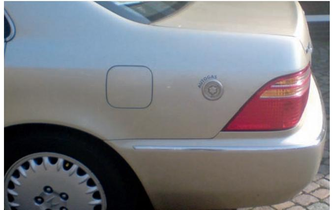
Füllanschluss eines Flüssiggasfahrzeugs
