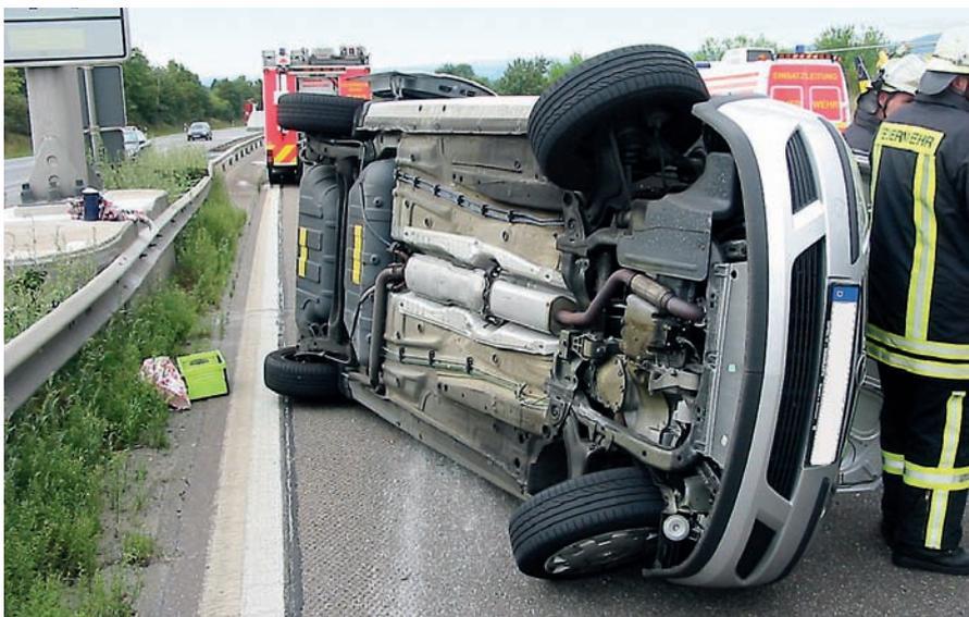
Bei diesem Unfallfahrzeug handelt es sich um ein Kraftfahrzeug mit Erdgasantrieb. Am Unterboden des Fahrzeuges ist im Heckbereich die Abdeckung der Gasflaschen zu erkennen.
