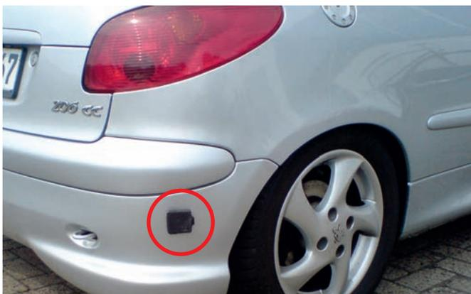
Füllanschluss eines Peugeot-Flüssiggasfahrzeugs im hinteren Stoßfänger (Kreis)
