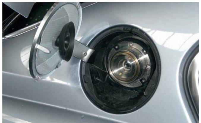
Im Bereich der C-Säule findet sich beim BMW Hydrogen 7 der spezielle Wasserstoff-Füllanschluss.
