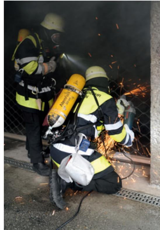
*Geschlossene Tore oder Gitter können einen Löschangriff in die Tiefgarage erschweren und einen Einsatz vom Öffnungs- oder Trennwerkzeugen erforderlich machen.*
