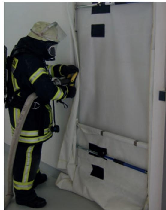
Sollen Schlauchleitungen durch geöffnete Rauchschutztüren geführt werden, so sind diese idealerweise mit mobilen Rauchverschlüssen zu sichern.
