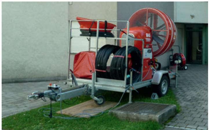
Die Belüftung von Gebäudeeingängen ist mit mobilen Großventilatoren auch auf größere Entfernungen möglich (je nach Gerätetyp bis zu 30 m Entfernung).
