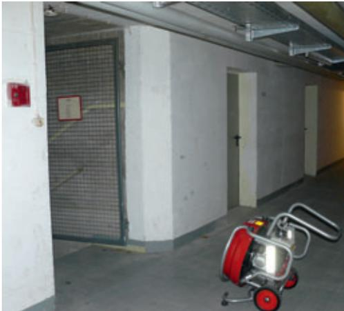
Lüftereinsatz innerhalb eines Verbindungsweges. Es muss sichergestellt sein, dass im rückwärtigen Bereich des Lüfters von außen genug Frischluft nachströmen kann.
