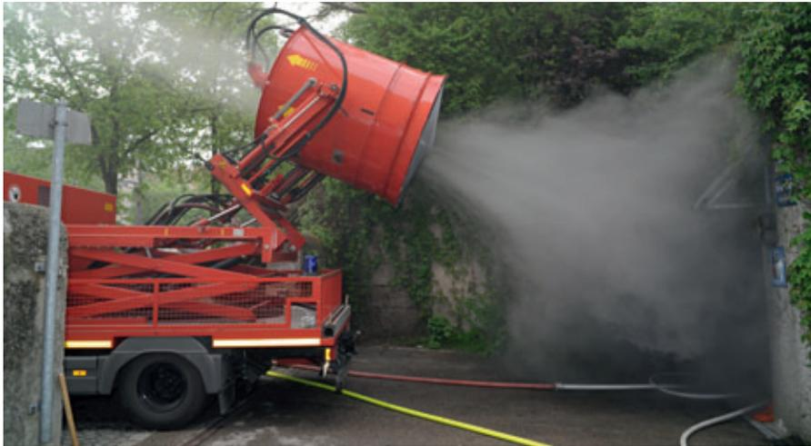
Möglichkeit einer Unterdruckbelüftung: Rauch wird mit dem MGV direkt abgesaugt. Hier ist der Wirkungsgrad deutlich geringer als bei einer Druckbelüftung.
