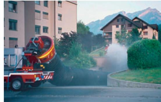
Steht keine Abluftöffnung für eine Druckbelüftung zur Verfügung, muss die Zuluftöffnung auch zum Abführen des Rauchs genutzt werden. Dann wird Luft mittels einer Lutte eingeblasen.
