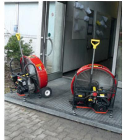
Effektiver ist der Einsatz der Lüfter, wenn sie parallel (nebeneinander) eingesetzt werden.
