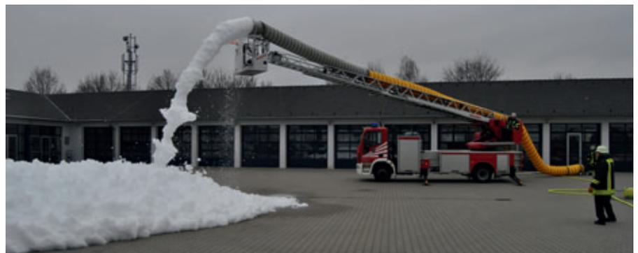
Das bei der BF Düsseldorf entwickelte Flexi Foam-System eignet sich zur Erzeugung größerer Schaummengen mithilfe eines Überdrucklüfters sehr gut, um Tiefgaragen mit Löschschaum zu fluten.
