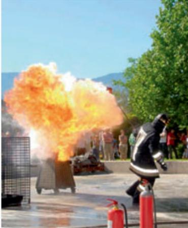
Fettexplosion beim Löschversuch mit Wasser.
