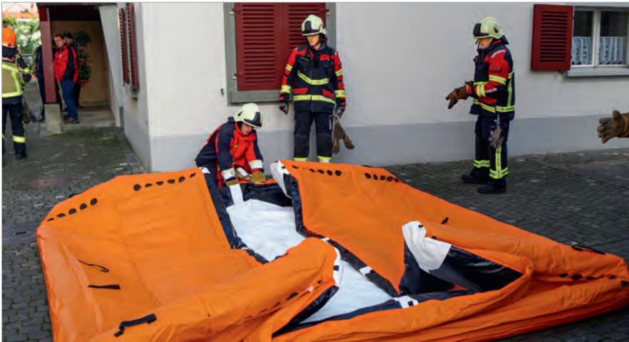
Das Sprungpolster System Lorsbach wird mit einer Pressluftflasche einsatzbereit gemacht.
