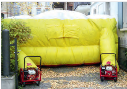
Sprungrettungsgeräte sind schnell aufgebaut und auch bei Platznot oder an für Drehleitern unzugänglichen engen Häuserfronten sofort zur Stelle.
