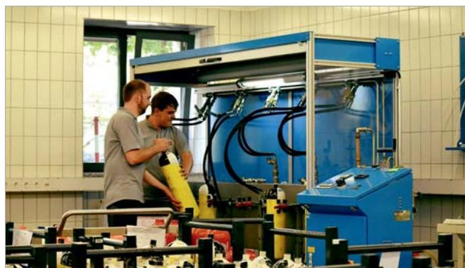
Manutenzione delle bombole di aria compressa
